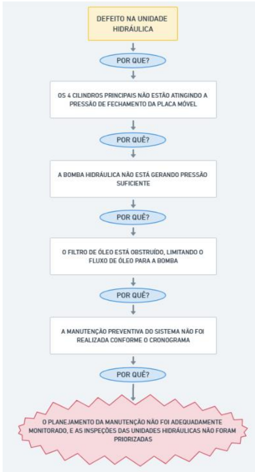
Figura 12: Identificação da Causa Fundamental da Falha da Unidade Hidráulica.
