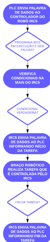
Figura 15 – Fluxograma da troca de dados entre robô e CLP. Fonte: Autor
