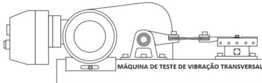
Figura 17 – Máquina de teste de vibração Junker
