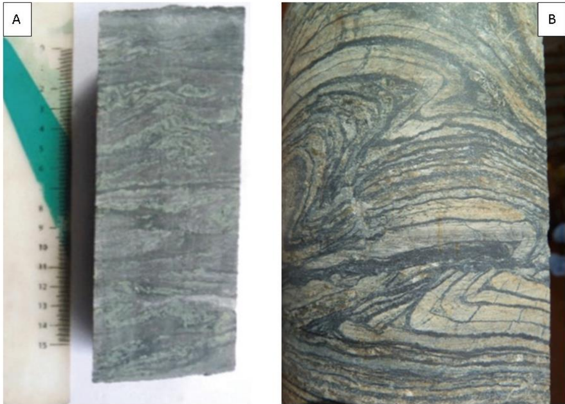
Figura 15 - A) Itabirito Anfibolítico ressaltando a alternância entre bandas claras dominadas por anfibólio e bandas escuras-cinzas compostas essencialmente por óxidos de ferro. B) Itabirito Magnetítico exibindo dobras milimétricas e composto por bandas claras compostas por quartzo e/ou carbonatos e bandas escuras compostas por óxidos de ferro
