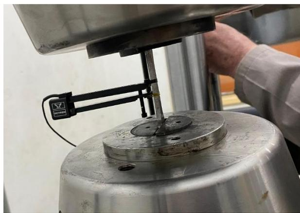
Figura 58: Extensômetro
