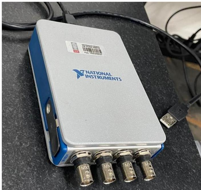
Figura 56: Módulo de entrada de tensão National Instruments NI-9239
