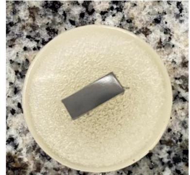
Figura 78: Amostra após ataque químico
