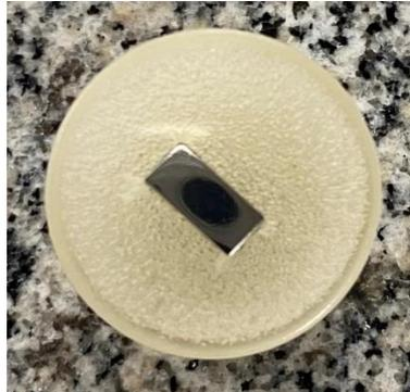
Figura 77: Amostra após o polimento
