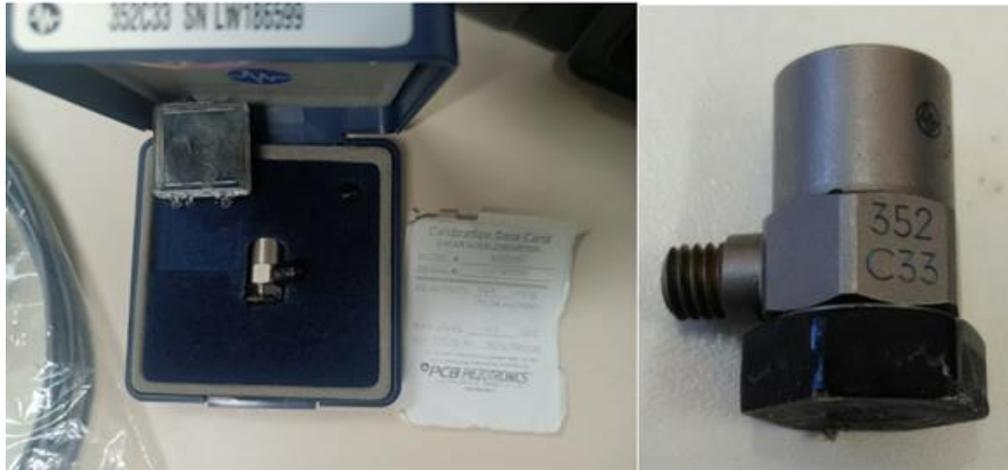
Figura 54: Acelerômetro *PCB Piezotronics* modelo 352C33
