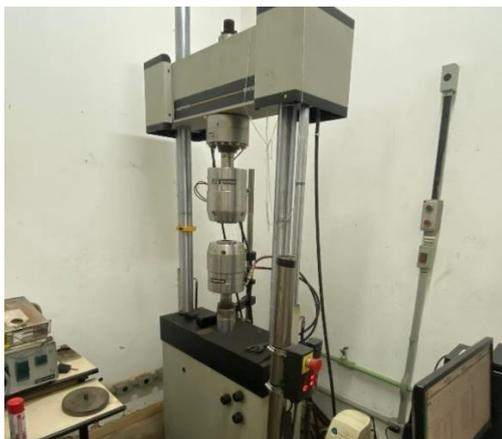
Figura 57: Máquina Universal de Ensaio
