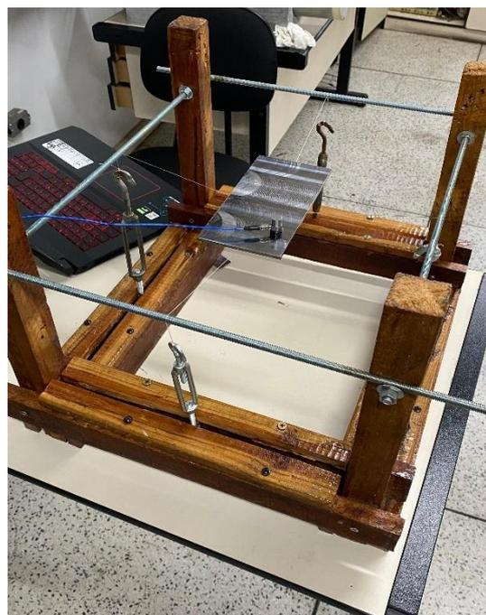
Figura 50: Dispositivo para ensaio com acelerômetro ( $0,5l$ )
