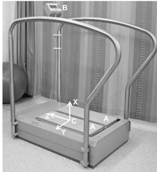
Figura 1. (A) Superfícies da swbv; (B) Interface homem-máquina; (C) Local de fixação do acelerômetro triaxial.
