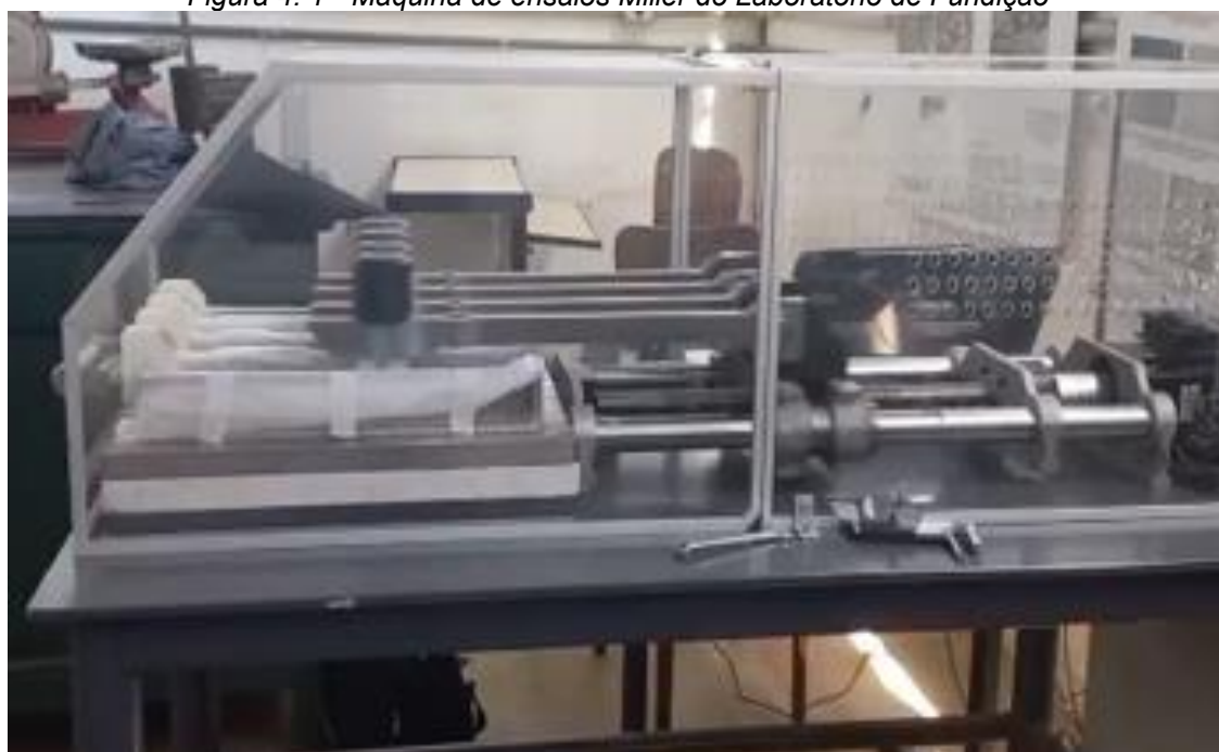
Figura 4. 1 - Máquina de ensaios Miller do Laboratório de Fundição
