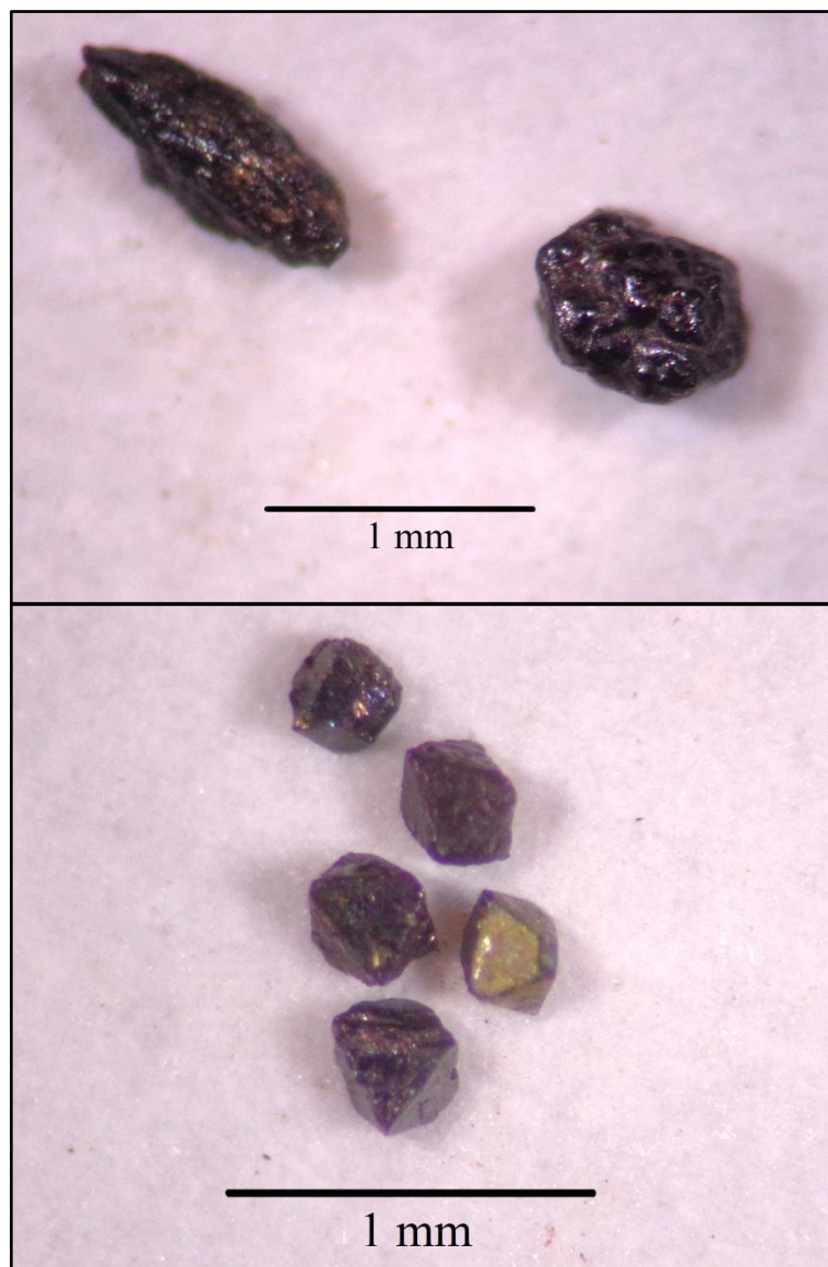
Figura 5.8 - Grãos de magnetita encontrados no ponto M1, barra emersa do rio Maracujá.
