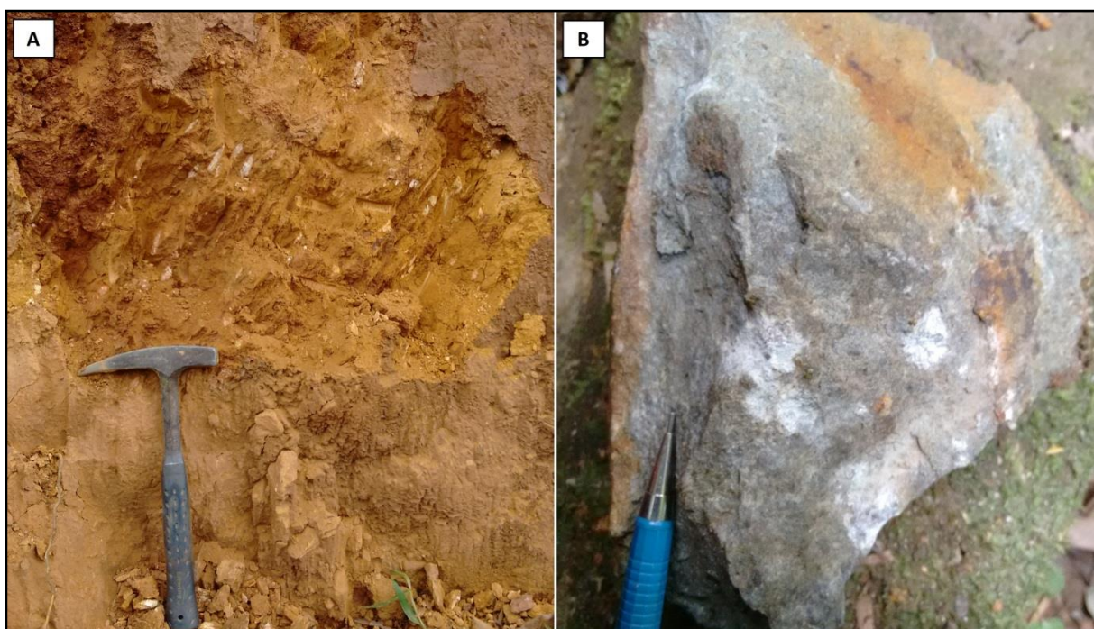
Figura 3.14 – Rocha intrusiva metabásica intemperizada, coloração ocre, exibindo fenocristais de caulim, provenientes do intemperismo de plagioclásios (Ponto E300); B) Amostra esverdeada de rocha máfica fresca com granulação muito fina (Ponto E236).
