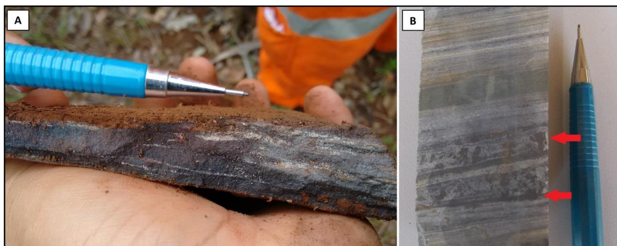
Figura 3.4 – A) Amostra de FFB parcialmente fresca evidenciada por bandas mais escuras de óxidos de ferro e outras mais claras de composição quartzosa (Ponto E12); B) Amostra de testemunho retirada da mina CdS II apresentando bandas quartzo-carbonáticas claras, subordinadas lentes de metapelito cloritizada em tons esverdeados e bandas de magnetita precipitada e na forma de cristais subédricos. Cristais estão destacados por setas vermelhas (furo de sondagem CS2BUD 0005).
