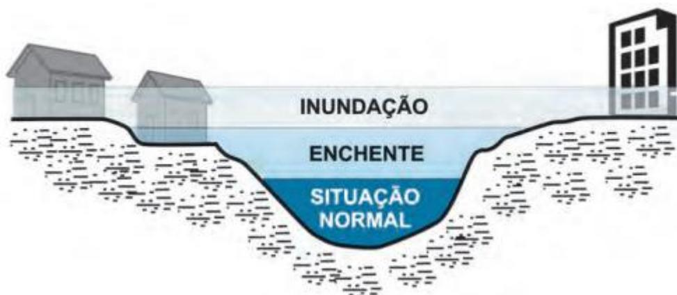
**Figura 3 - Perfil esquemático do processo de enchente e inundação**
