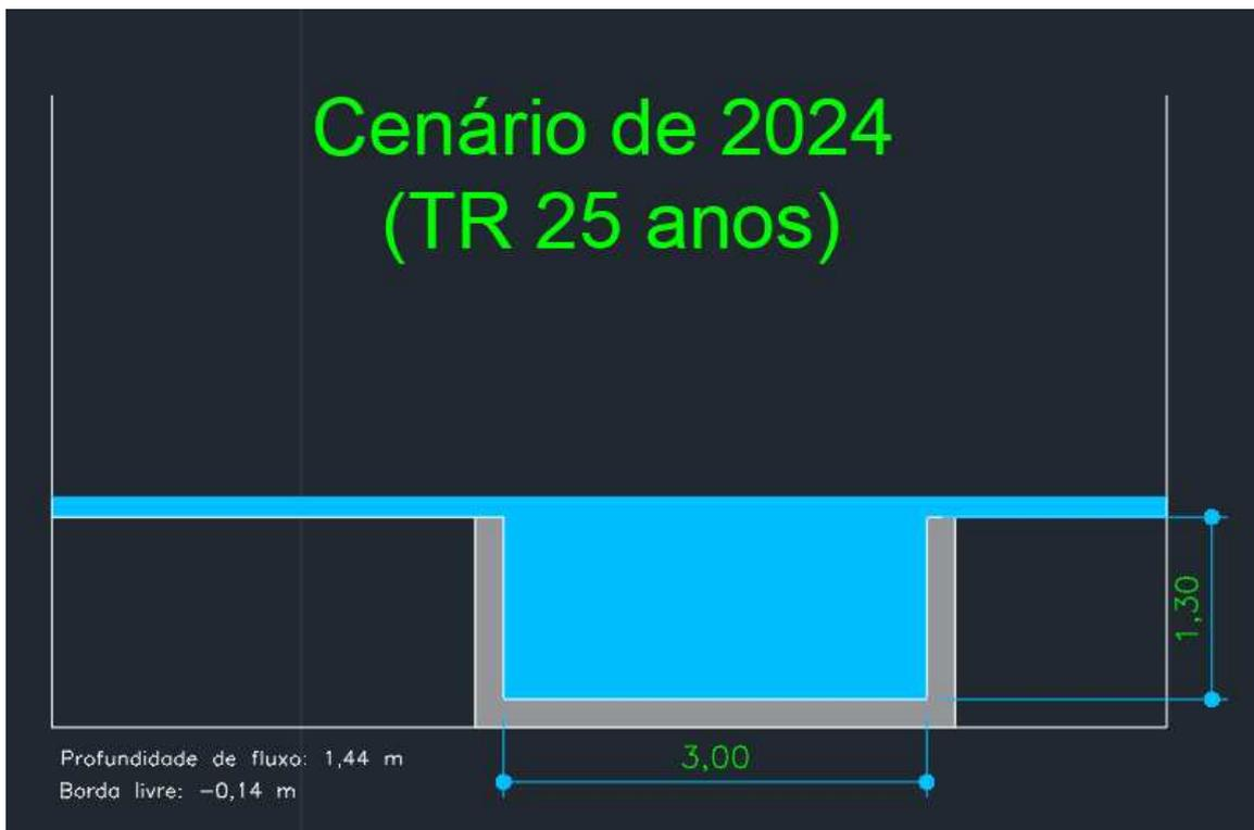
**Figura 23 - Seção transversal do Trecho 4 em 2024, dimensões medidas *in loco***
