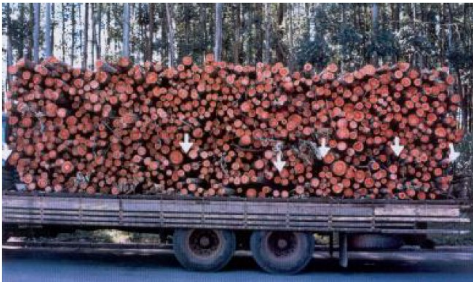
Figura 9 – Vista da carroceria de um caminhão com vários “espaços” ocasionados pelo mal empilhamento acidental ou proposital.
