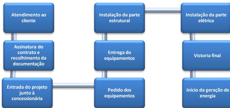
Figura 10: Processos envolvidos na execução de uma usina solar
