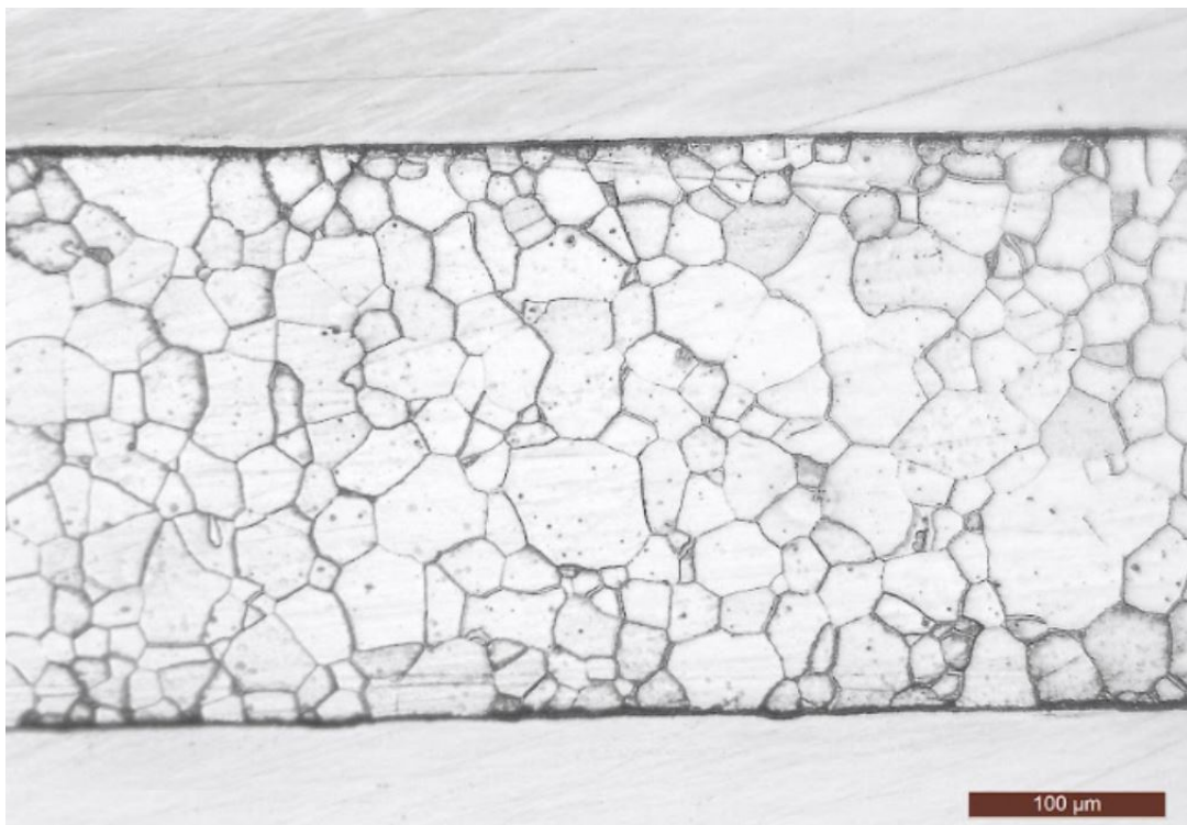
Figura 4 – Aspectos de grão em aço elétrico GO após linha de descarbonetação.
