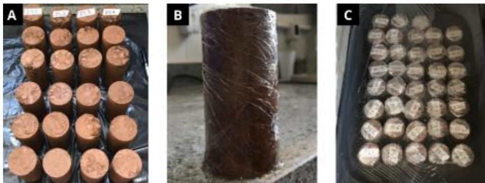
Figura 23 - Corpos de prova iniciando o processo de cura.
