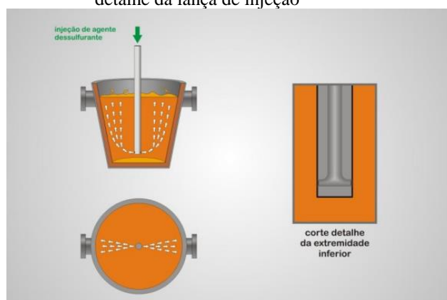
Figura 3.13: Desenho esquemático de injeção de agente dessulfurante em panela; vista lateral, vista superior e detalhe da lança de injeção
