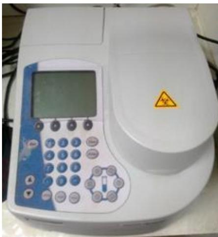
*Figura 4.1: Espectrofotômetro Genesys 10S UV-Vis, Thermo Scientific. Laboratório de Química Estrutural e Inorgânica - Universidade Federal de Ouro Preto - Departamento de Química*
