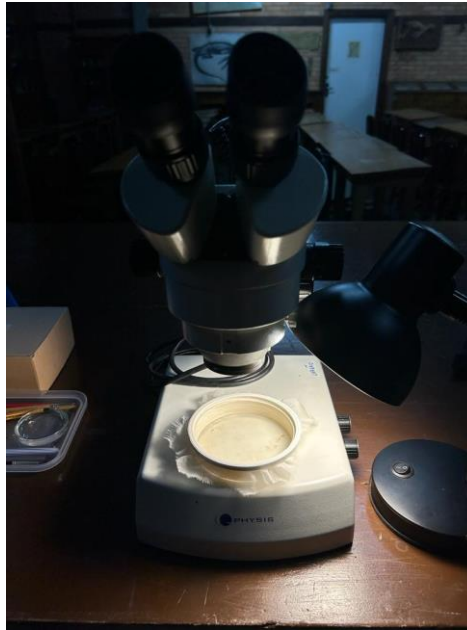
Figura 4.5 - Microscópio estereoscópico com aumento de 15X para identificação de partículas de carvão.
