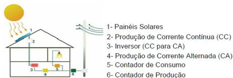
**Figura 5: Sistema solar interligado a rede. Fonte: (REMES, 2013) ADAPTADO.**
