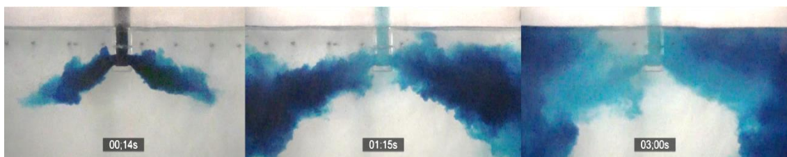
Figura 5.13 – Dispersão de corante ao longo do tempo dentro do molde utilizando a imersão de 16cm, válvula SEN original, vazão de água de 185L/min e sem vazão de ar
