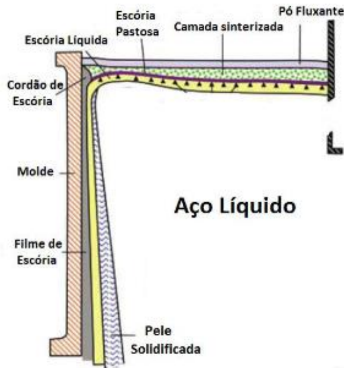
Figura 3.3 – Visão esquemática das camadas formadas no topo do molde
