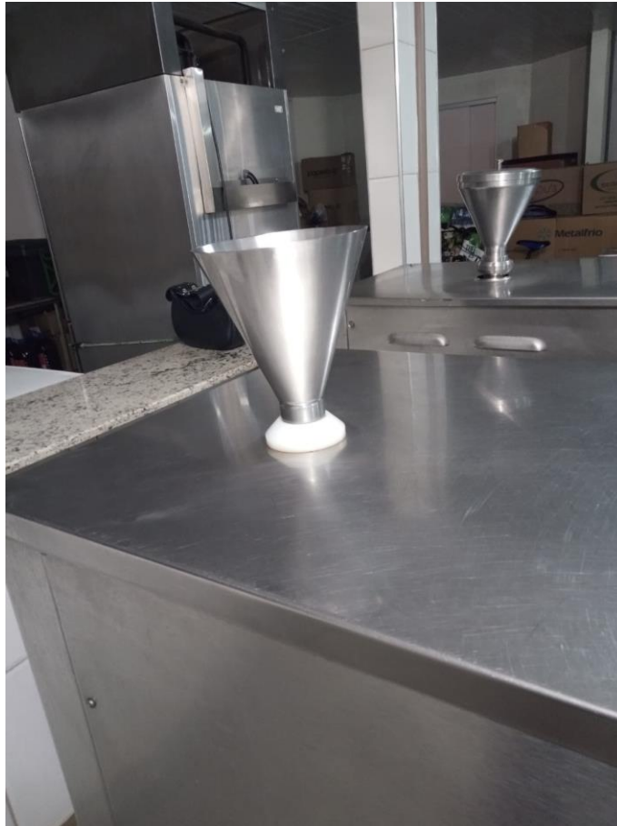
Figura 18 - Funil onde o balde de calda é despejado na máquina produtora
