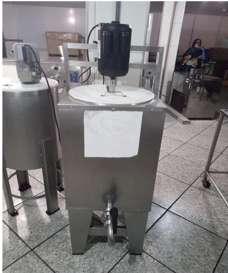
Figura 16 - Liquidificador Industrial usado na etapa de homogeneização
