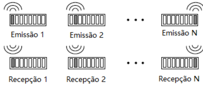
Figura 11 – Array com N elementos transdutores.
