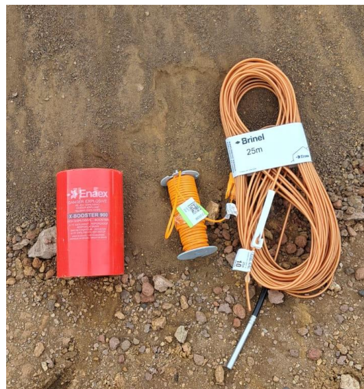
Figura 23 - Kit de acessórios utilizados em cada furo. (Da esquerda para a direita) Reforçador, detonador eletrônico, detonador não elétrico.
