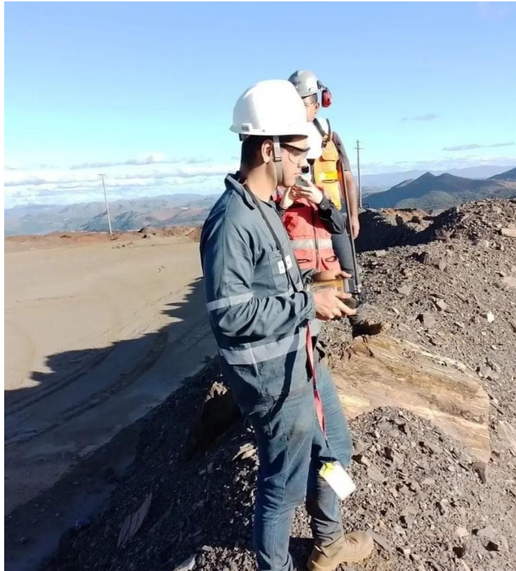
Figura 21 - Disparo de fogo, utilizando o sistema de iniciação eletrônica
