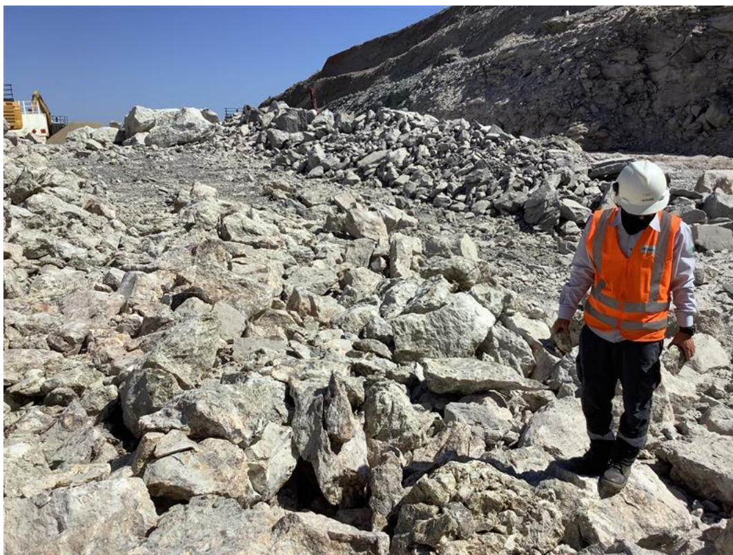
Figura 25 - Realização de levantamento para análise granulométrica em pilha desmontada.
