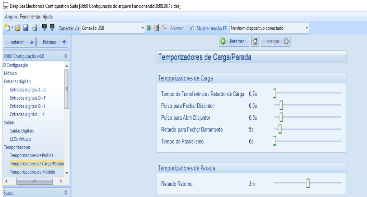
Figura 5.6: Configuração do temporizador de carga/parada
