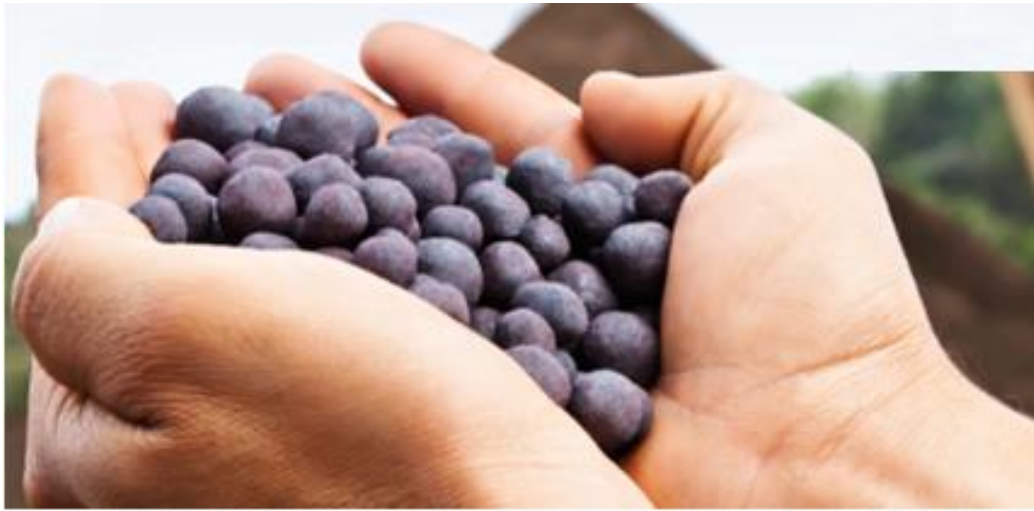
Figura 2.1: Pelotas de minério de ferro
