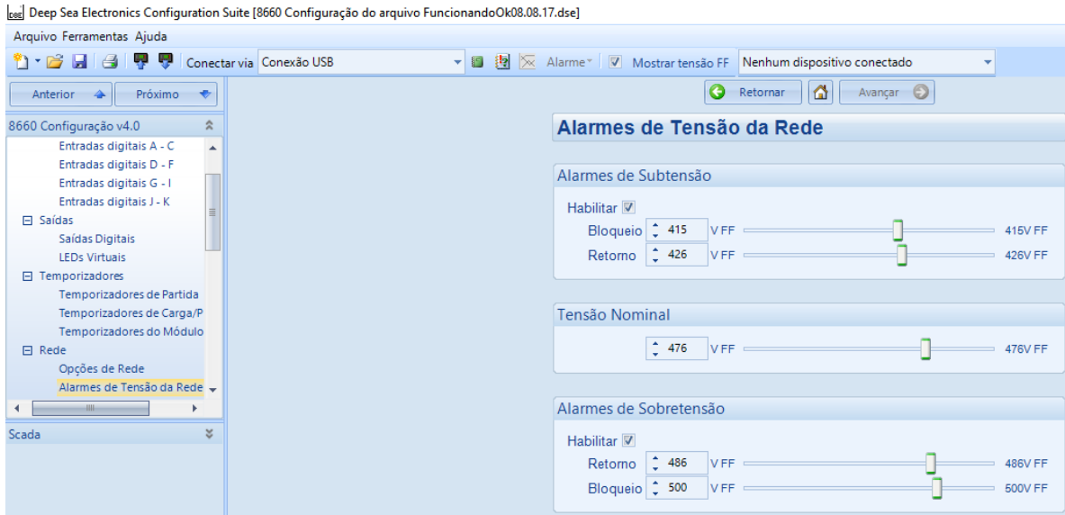
Figura 5.8: Configuração dos alarmes de tensão de rede
