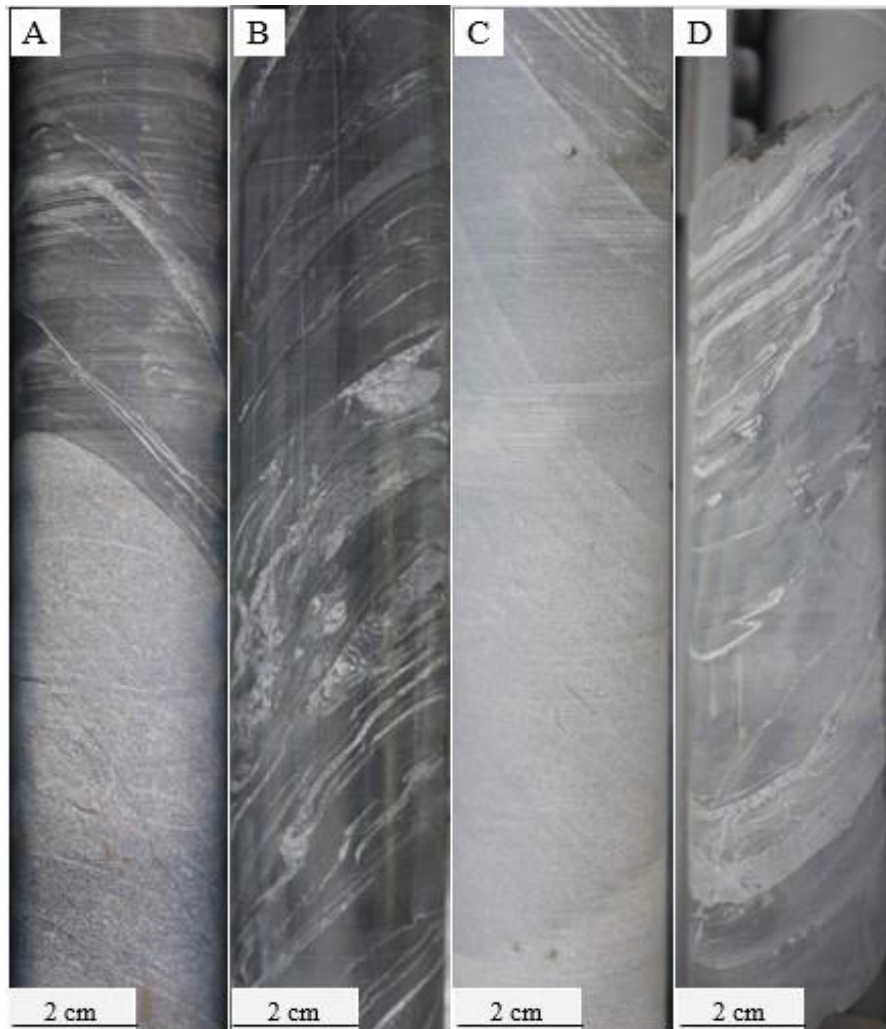
Figura 4.1 - Principais feições macroscópicas dos litotipos hospedeiros dos alvos Laranjeiras e Carvoaria. a) Contato entre metapelito, cinza escuro e metagrauva cinza claro. b) Predominância de metapelitos com venulações quartzo-carbonáticas intercaladas. c) Predominância de metagrauva com finas venulações. d) Contato entre rochas dobrado.
