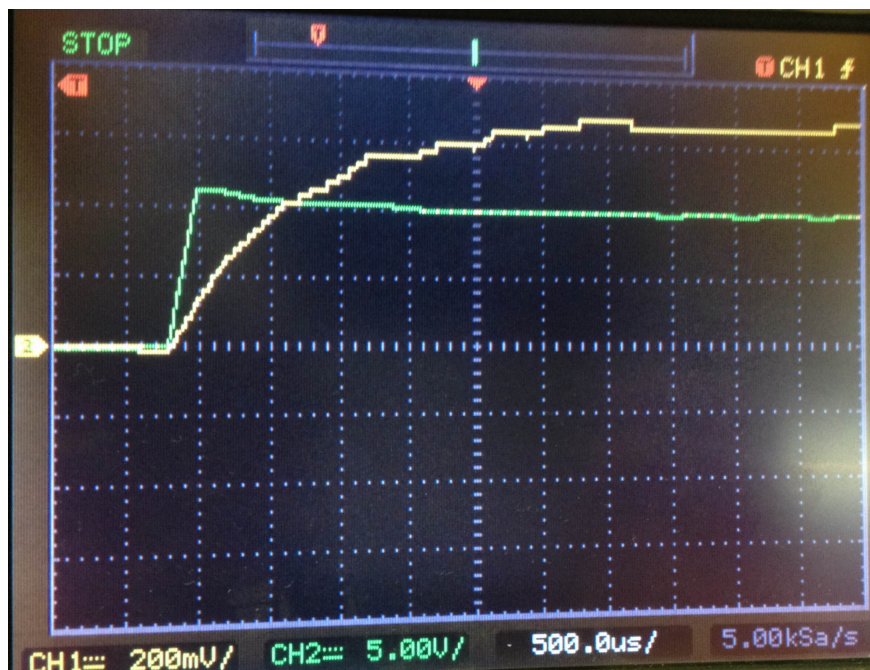
Figura 14: Teste Teste de Corrente com Rotor Bloqueado
