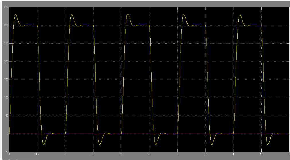
Figura 26: Teste Resposta a uma onda quadrada do sistema simulado, com integrador na malha
