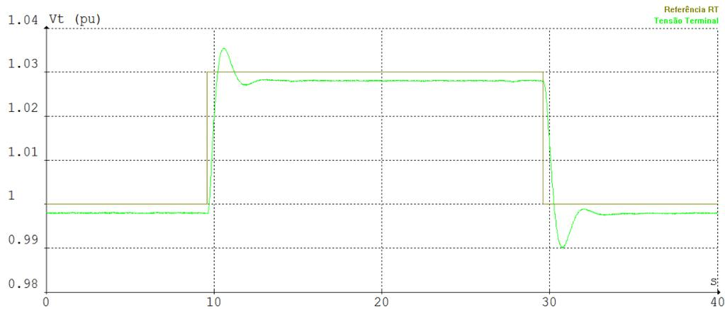
Figura 66 - Controle de tensão terminal resposta ao degrau de 3%. Fonte: Reivax (2017)
