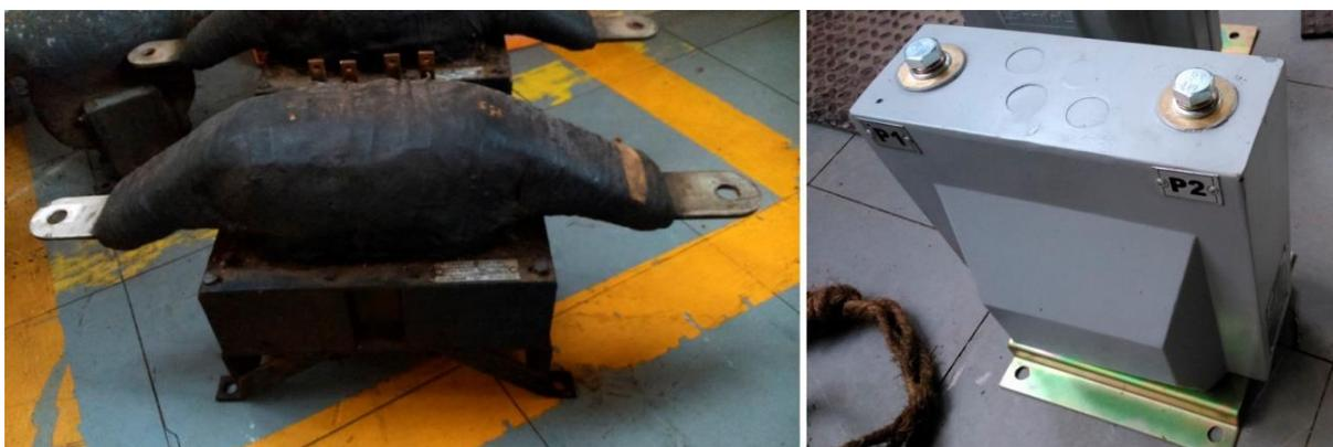
Figura 25 - TC antigo à esquerda e TC novo à direita. Fonte: o autor.
