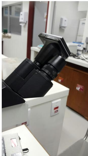
Figura 7 – Câmera anexada ao ocular do microscópio
