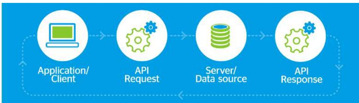
**Figura 2.22 - O funcionamento de uma API**
