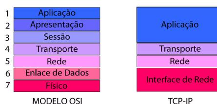
**Figura 2.13 - Comparação entre o modelo OSI e TCP/IP**
