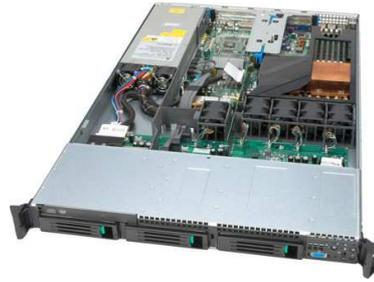
**Figura 2.17 - Hardware interno de um servidor**
