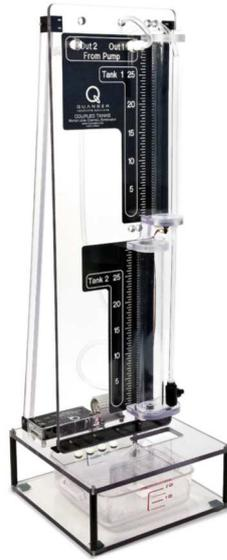
**Figura 2.23 - Sistema de Tanques Acoplados da Quanser**
