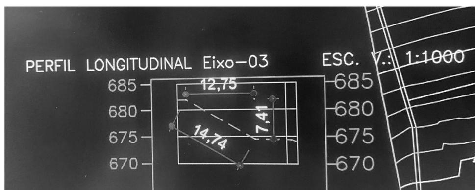
Figura 31 e 32 - Representação das dimensões do talude.
