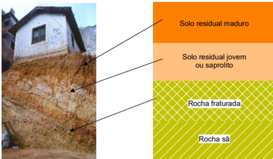
Figura 1 - Perfil geotécnico típico de solo residual de gneiss do Rio de Janeiro.
