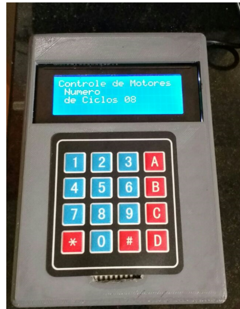
(b) Projeto finalizado embarcado em uma case de acrílico
