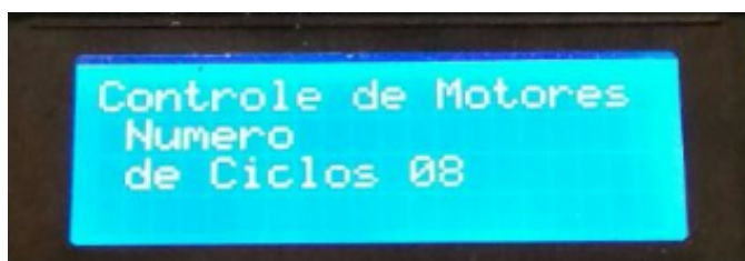
Figura 28 – Funcionamento correto do display LCD
