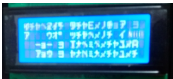
Figura 27 – Interferência do display LCD ao acionar o módulo relé
