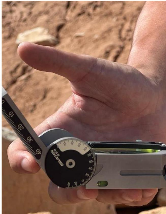
**Figura 15** – Equipamento demonstrando o ângulo da face do talude *in loco* pelo discente. Fonte: o autor, 2023.
