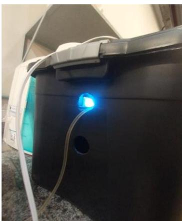
A Figura 12 mostra o protótipo 2 durante a realização do ensaio do tipo fluxo contínuo. Inicialmente o efluente foi depositado em um balde, onde encontra-se acoplada a bomba, que bombeia o material para dentro da caixa, onde está instalada a lâmpada LED UV.
