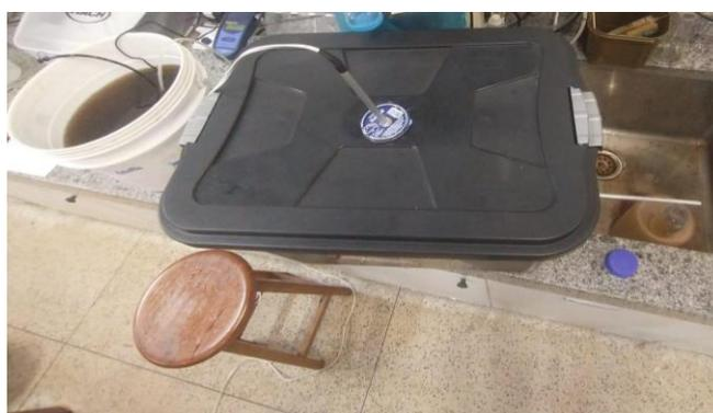
Como o tempo de detenção hidráulica é de 49 minutos foram retiradas 5 amostras. Sendo uma antes do efluente passar pelo tratamento e outras 4 em tempos distintos do tratamento. A segunda amostra foi retirada após atingido o tempo de detenção de 49 minutos. Decidiu-se dobrar o tempo para ver se os resultados seriam melhores e assim a terceira amostra foi retirada após 98 min, a quarta após 147 min, a quinta após 196 min.
