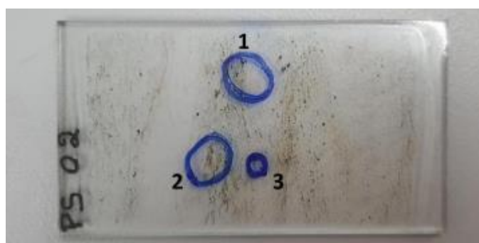
Figura 3.4: Lâmina delgada PS-02 de xisto pelítico evidenciando as marcações dos campos para análise.
