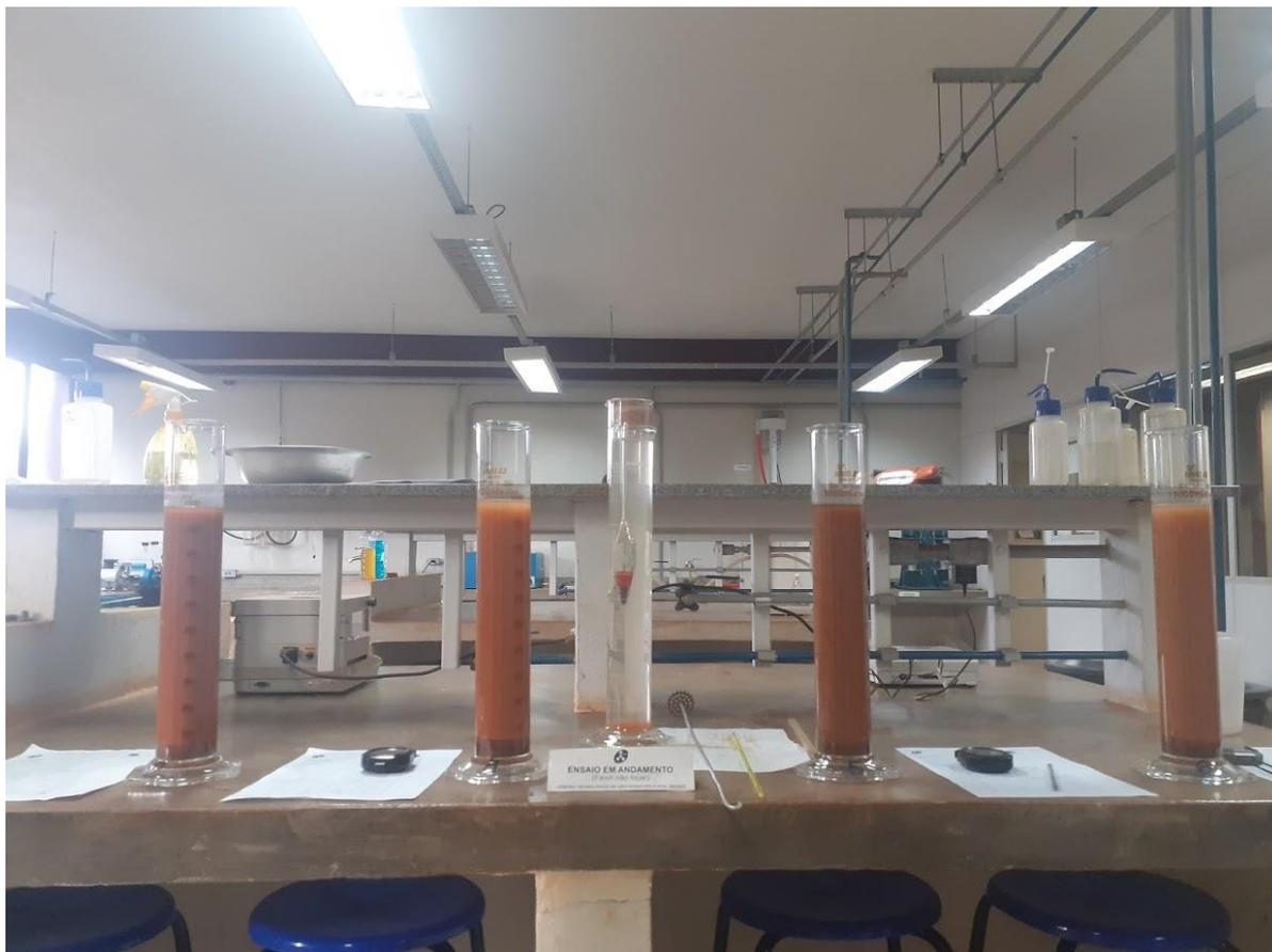
Figura 3.10: Provetas dispostas sobre a bancada com os outros materiais utilizados durante ensaio de sedimentação.
