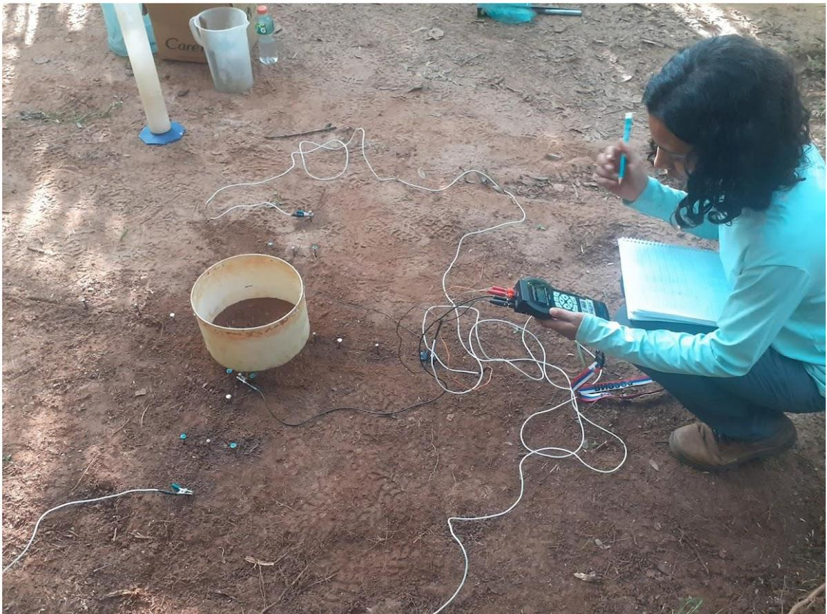
Figura 3.4: Esquema de montagem dos arranjos de eletrodos em volta do Infiltrômetro de Anel.
