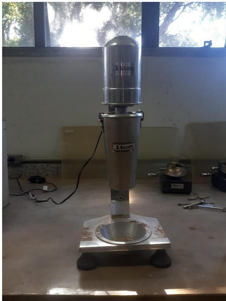
Figura 3.9: Copo dispersor utilizado nos ensaios.
