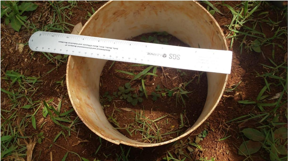
Figura 3.2: Tubo de PVC utilizado com 250 mm de diâmetro.
