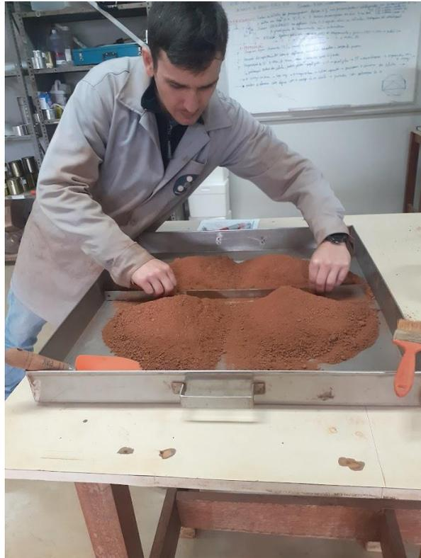
Figura 3.6: Parte do procedimento de quartamento de amostra total de solo.
