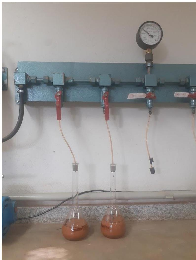
Figura 3.12: amostras nos picnômetros submetidas ao vácuo.
