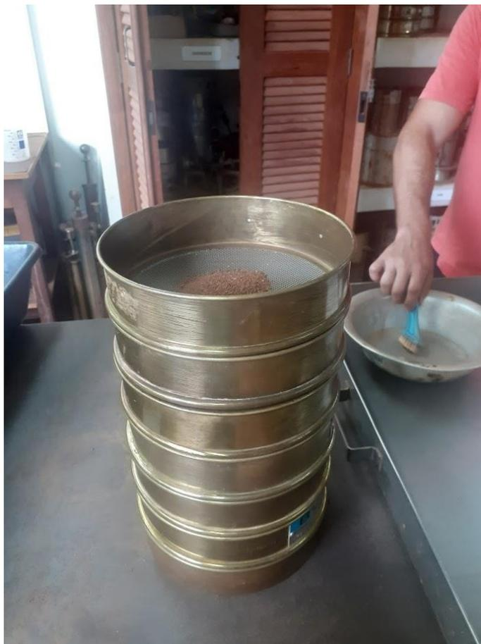
Figura 3.8: Conjunto de peneiras utilizadas durante o peneiramento fino da amostra após o ensaio de sedimentação e secagem em estufa.
