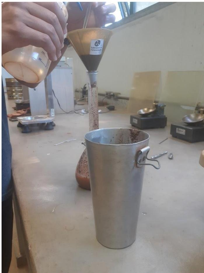
Figura 3.11: Transferência da amostra do dispersor para o picnômetro.
