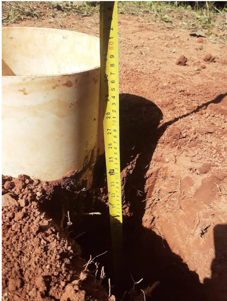
Figura 3.5: Limite da trincheira aberta no local onde se encontrava o anel infiltrômetro para coleta de amostras.
