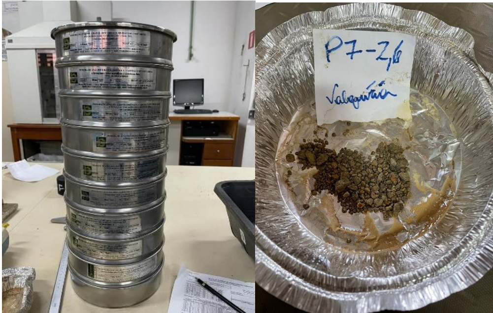
Figura 16-Análise granulométrica por peneiramento
