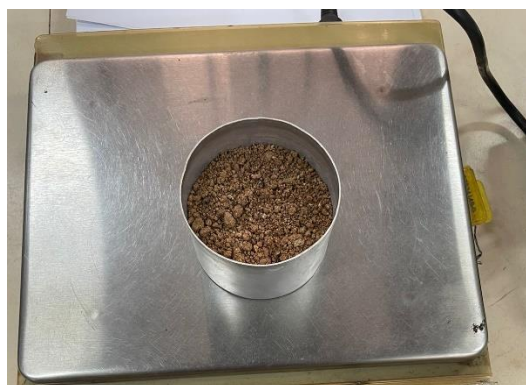
Figura 20- Ensaio de Teor de Umidade.
