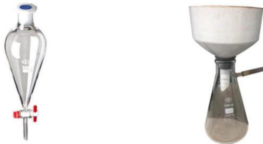
Figura 23 Funil separador e Filtro
