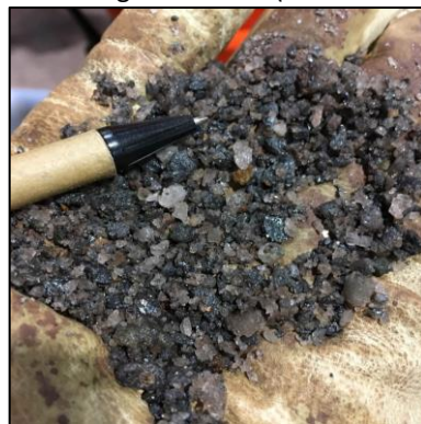
Figura 2 Sílica liberada na carga circulante (Oversize da Peneira Secundária)
