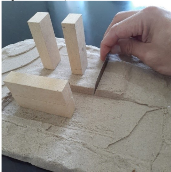
Figura 17 - Remoção de areia com lâmina de estilete
