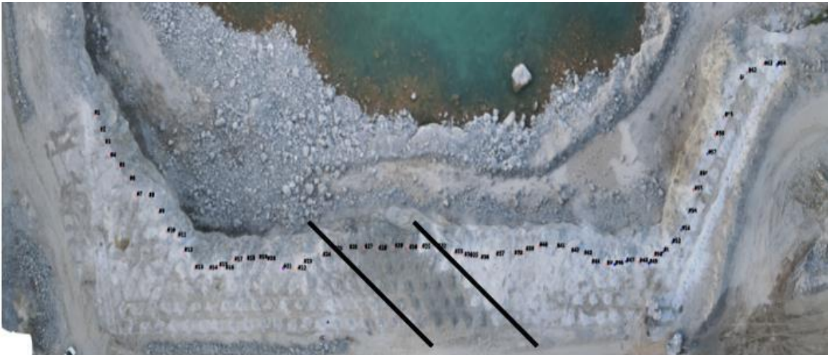
Figura 17 - Dique máfico, vista aérea da detonação
