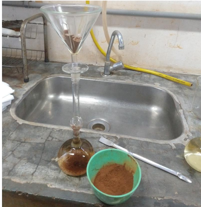
Figura 21 - Lodo sendo despejado no frasco de querosene
