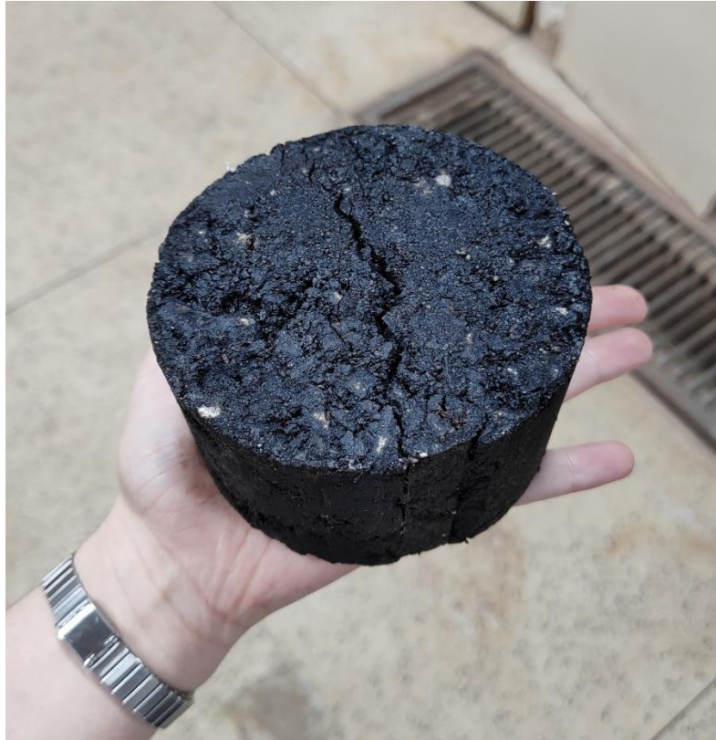
Figura 40 - CP após ensaio de resistência à tração
