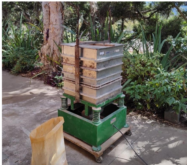
Figura 18 - Peneiramento do lodo
