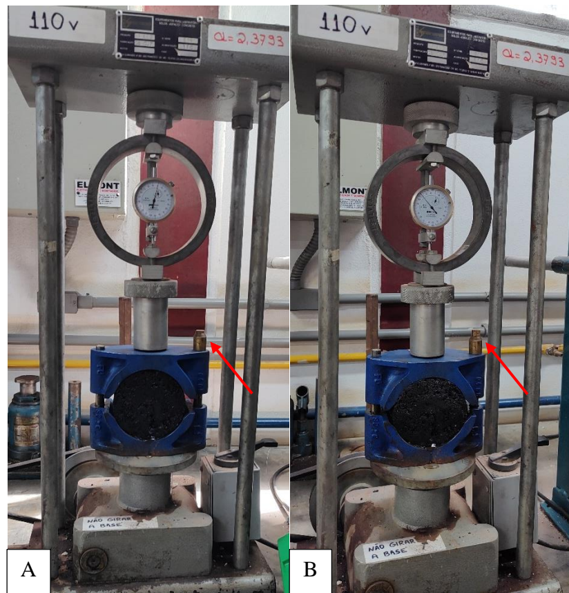
Figura 37 - Medidor de fluência (A) no início do ensaio (B) no final do ensaio
