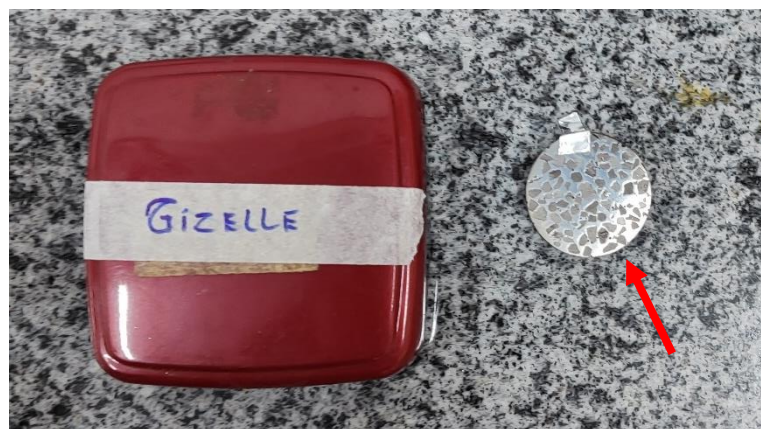
Figura 15 - Amostra para realização da MEV
