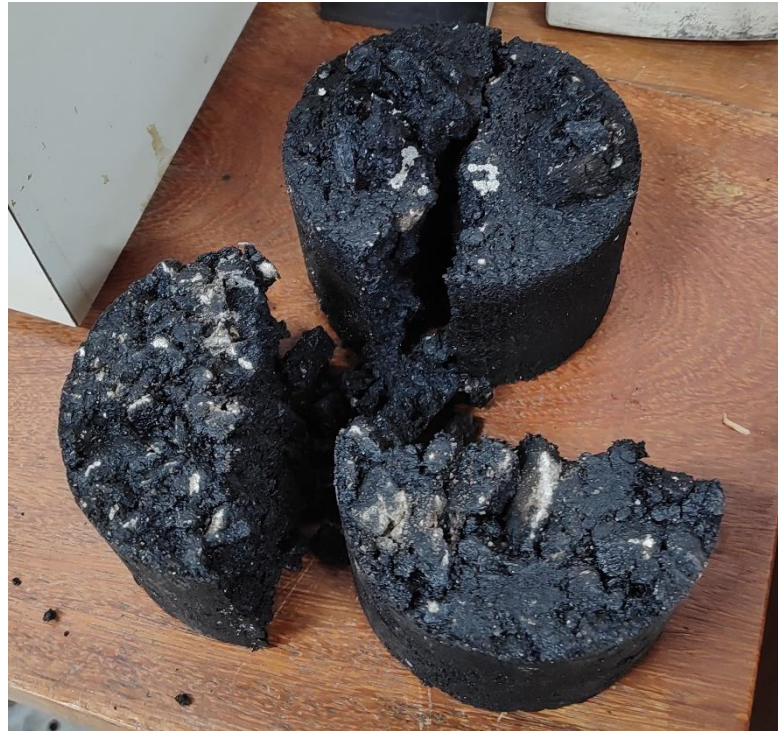
Figura 45 - CPs rompidos no ensaio de Fadiga
