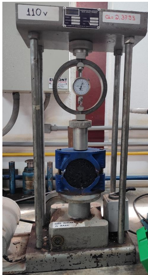
Figura 36 - CP no molde de compressão
