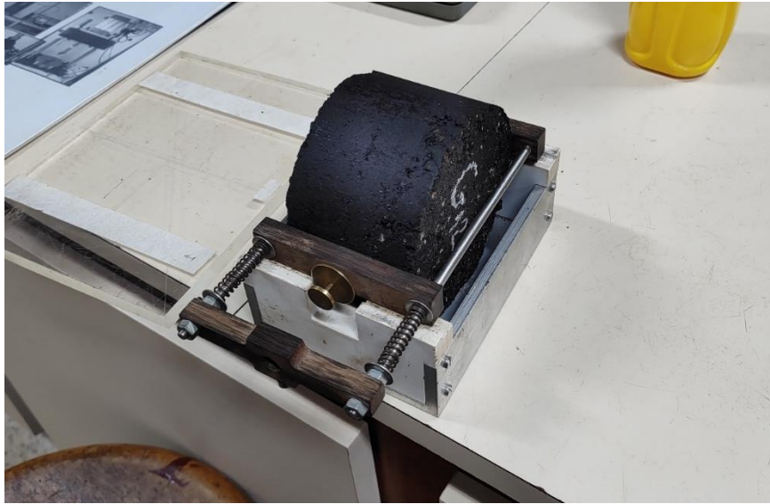
Figura 41 - Preparação do CP para determinação do Módulo de Resiliência
