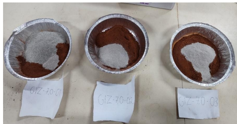
Figura 28 - Separação da composição granulométrica para 7,0% de ligante asfáltico
