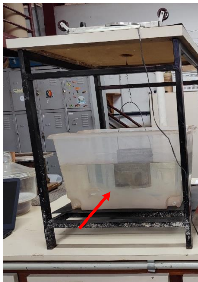
Figura 34 - Esquema para obtenção da massa submersa do CP
