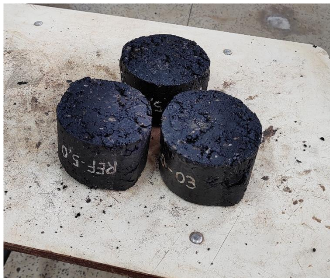
Figura 38 - CPs após realização do ensaio de Estabilidade e Fluência
