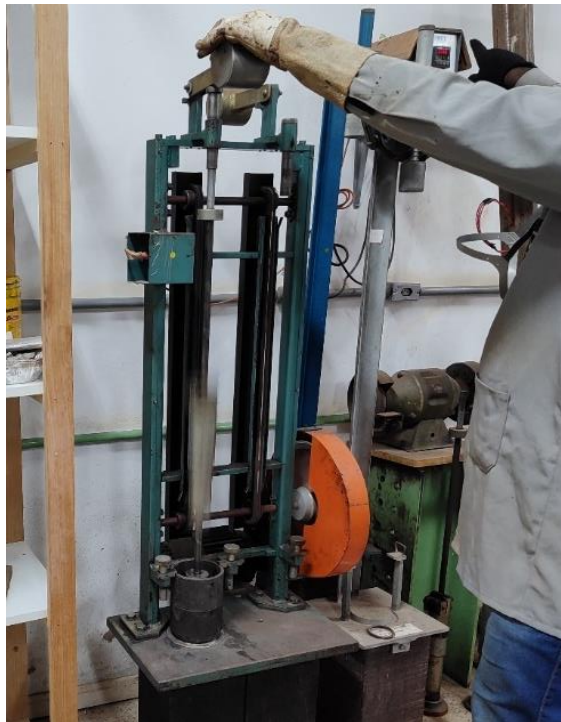
Figura 24 - Compactação do CP de referência
