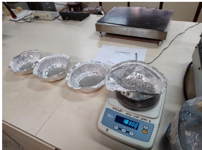
Figura 22 - Preparação dos agregados
