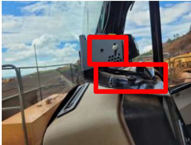
Figura 13 - Suporte inadequado do DSS
