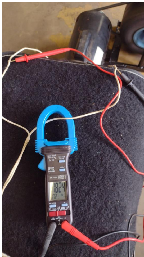
Figura 19 – Aferição da Potência sem Vela Fonte: Pesquisa Direta (2023)
