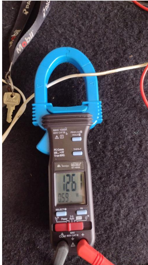
Figura 21 – Aferição da Potência em Neutro. Fonte: Pesquisa Direta (2023)
