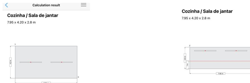
Figura 35 – Posições aonde as luminárias devem ser instaladas na cozinha/sala de jantar.
