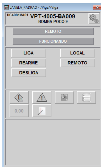
Figura 37 – Janela de comando da bomba.
