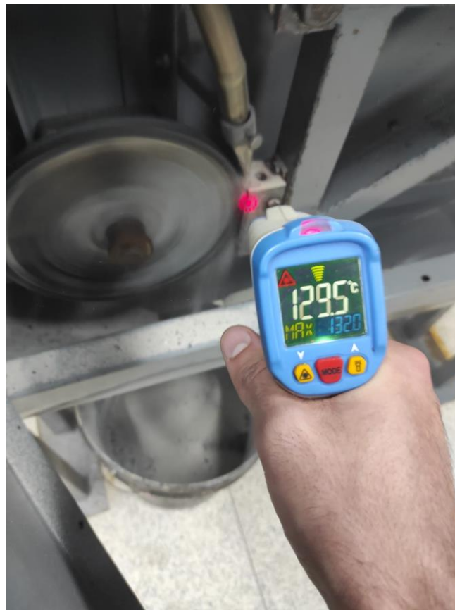
Figura 29 - Monitoramento da temperatura durante o ensaio de desgaste abrasivo. Fonte: Pesquisa direta (2023).
