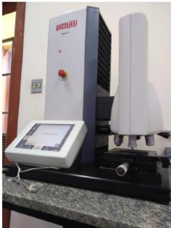
Figura 19 - Durômetro Emcotest. Fonte: Pesquisa direta (2023).
