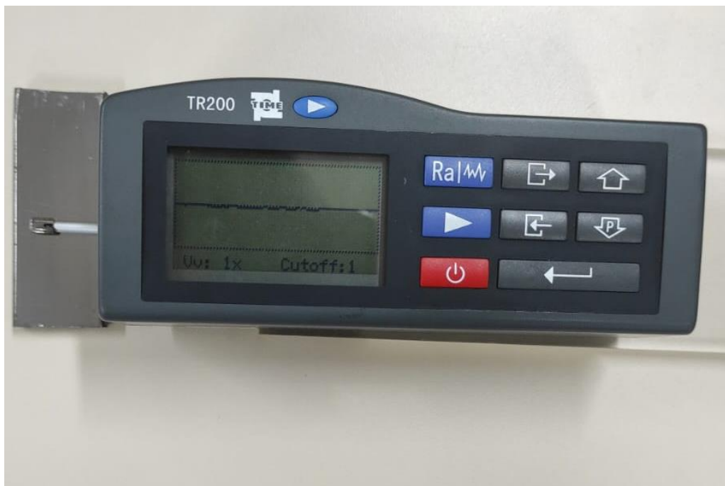
Figura 22 - Medição de superfície com rugosímetro. Fonte: Pesquisa direta (2023).
