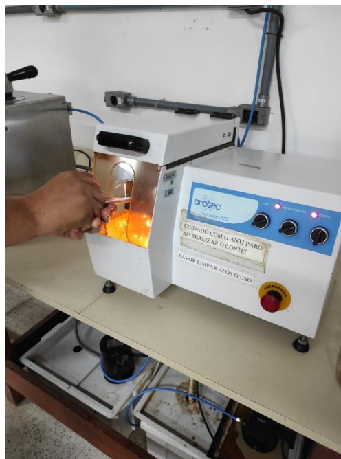
Figura 15 - Amostra em processo de corte. Fonte: Pesquisa direta (2023).
