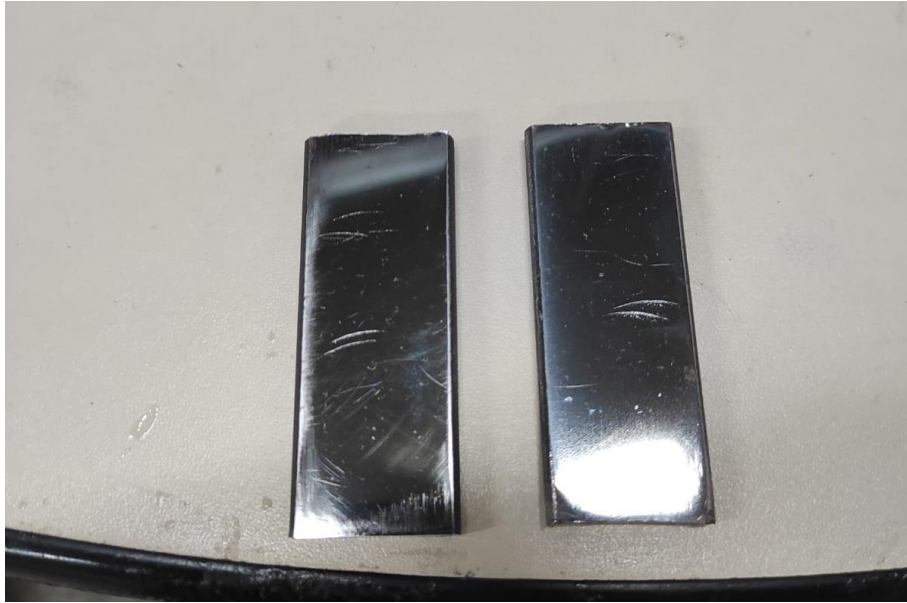
Figura 21 - Corpos de prova lixados e polidos. Fonte: Pesquisa direta (2023).
