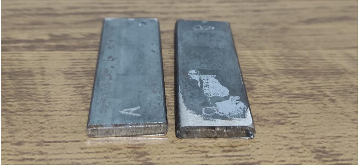
Figura 20 - Corpos de prova sem preparação superficial. Fonte: Pesquisa direta (2023).
