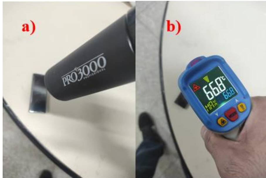
Figura 26 - a) Corpo de prova A sendo aquecido. b) Temperatura do corpo de prova A após 10 minutos de aquecimento. Fonte: Pesquisa direta (2023).
