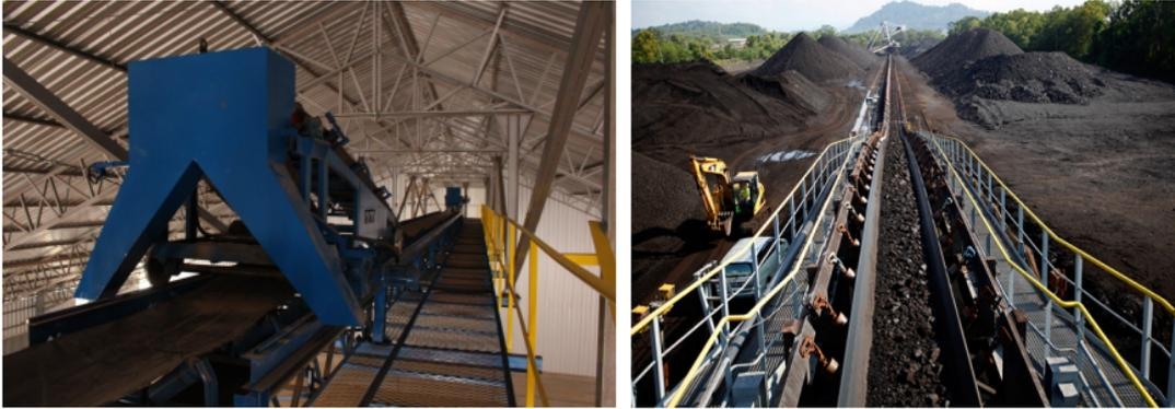
Figura 1 – Carro *tripper* e correia transportadora. Fonte: Santos (2019)
