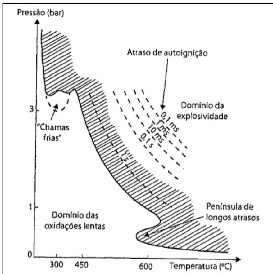
Figura 15: Oxidação lenta e autoignição para uma mistura de n-heptano/ar Fonte: (BRUNETTI, 2012)
