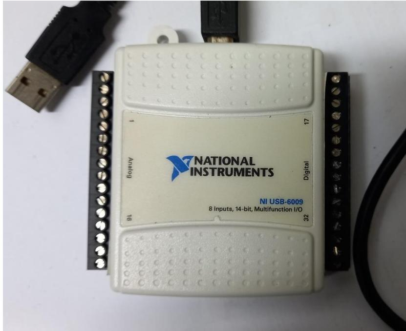
Figura 27: Placa de aquisição.
