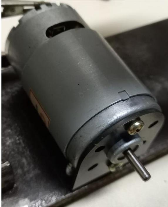
Figura 21: Motor de corrente contínua.
