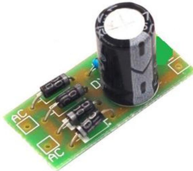
Figura 13: Exemplo de um circuito retificador.
