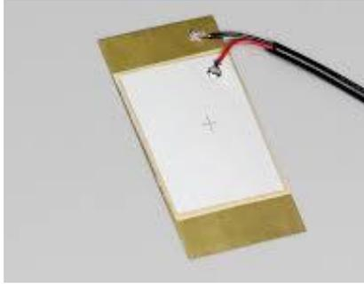
Figura 24: Chapa de latão com lâminas de PZT-5H (viga).
