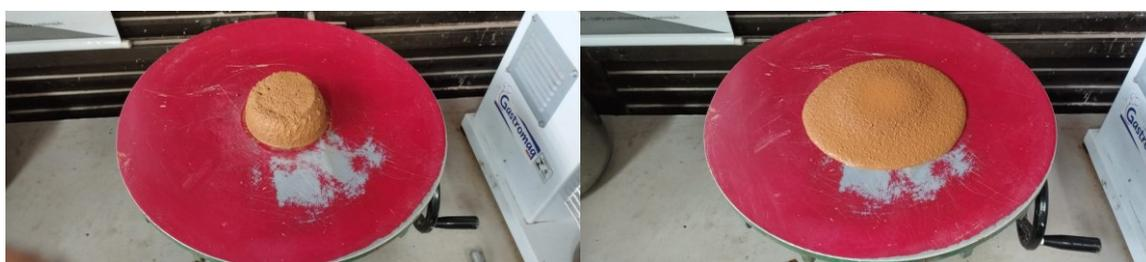
**Figura 13 - Cone de cimento e abatimento do material.**
