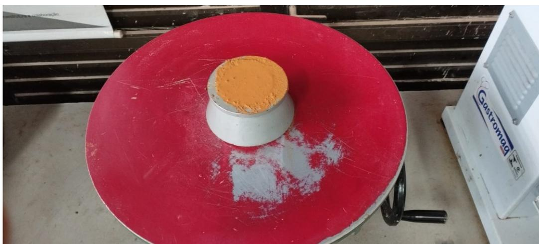
**Figura 12 - Ensaio de consistência.**
