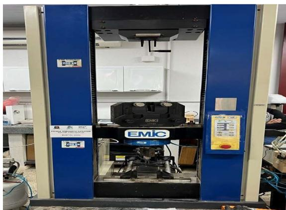
**Figura 16 - Prensa servo-controlado universal - EMIC 20000/PC200 do LMC/UFOP.**
