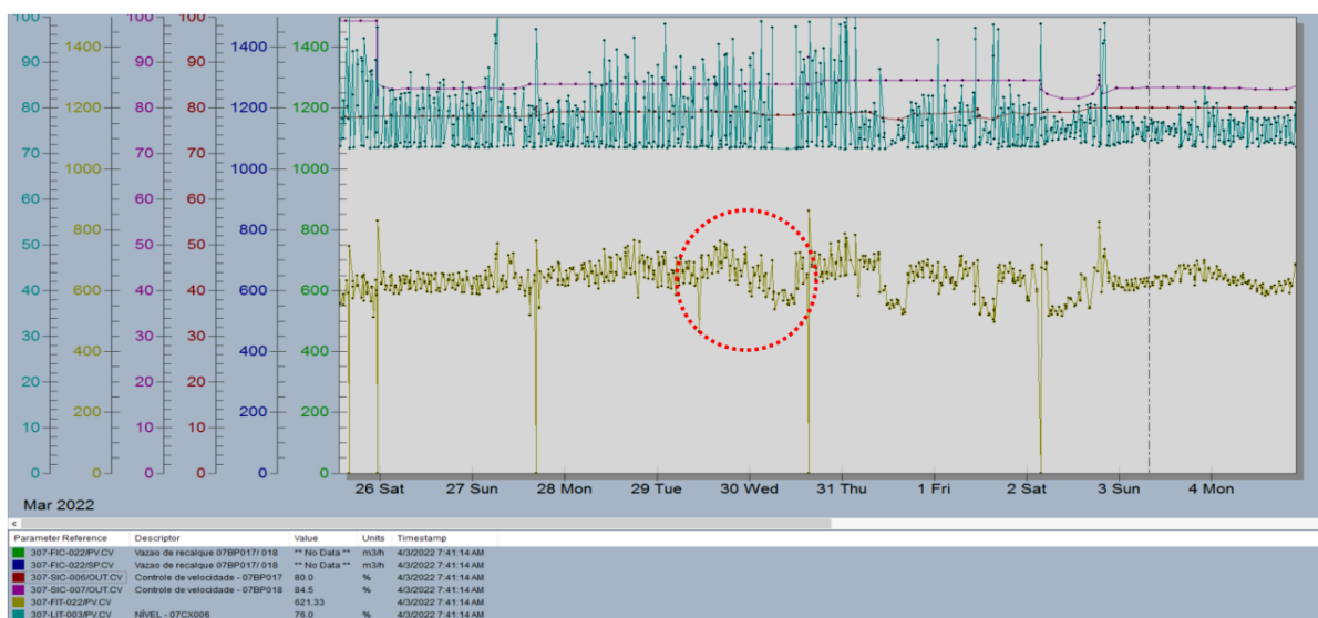
Figura 22 – Gráfico gerado antes da criação da malha de controle. Vazão representada pela linha amarela.
