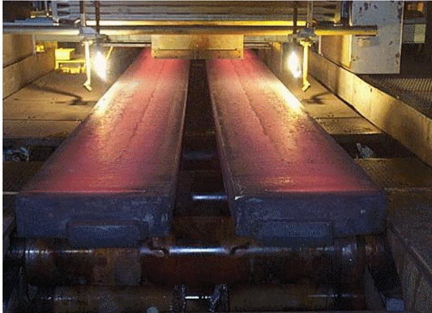
Figura 10 – Corte de placas de aço.
